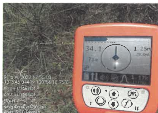
รูปที่ 2-14 การตรวจสอบแนวท่อของหน่วยสายตรวจเคลื่อนที่
